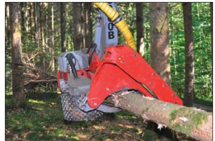
Mit der richtigen Einstellung verbleibt der Grossteil der Rinde am Stamm. Entscheidend für die Stangeholzernte. (Bild: det)
